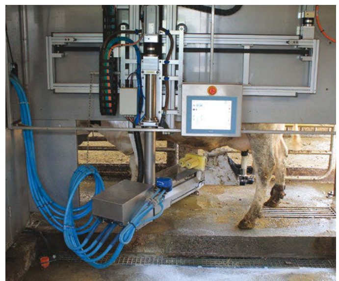
Il Fullwood M 2 erlin, sempre della Tdm, è il secondo robot di mungitura installato presso l'azienda Bombana, a fine maggio 2015. La movimentazione del braccio di mungitura è totalmente elettrica, molto più silenziosa e precisa del modello precedente.
