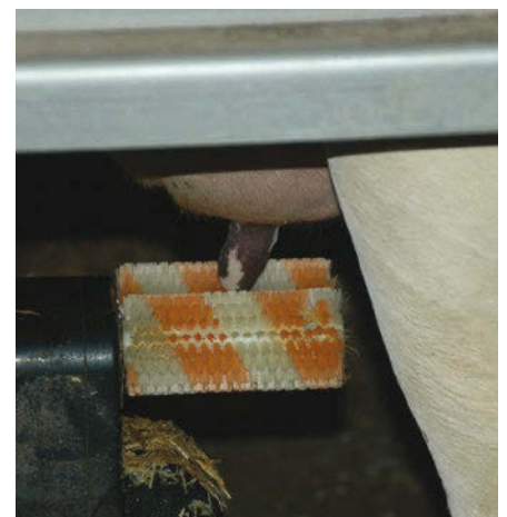
Il sistema di spazzolamento e pulizia della mammella si auto-pulisce a ogni vacca.
